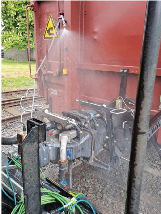
Abbildung 1: Gezielte Bewässerung einer Kupplungsstelle
